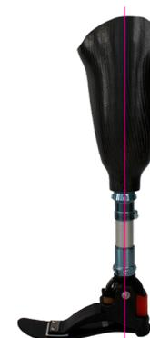
Zur Anordnung des Fußes in der A/P-Ebene orientieren Sie sich an der Knöchelachse und positionieren diese ca. 0 - 5 mm rückverlagert zur Position des Schaftes.
